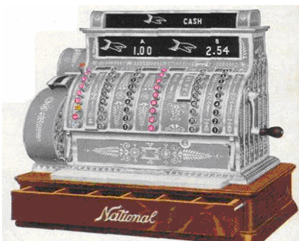
Figura 34 – Registradora NCR 462, aquesta registradora comença a ser molt més sofisticada i a més permet moure i desfer els errors realitzats durant el cobrament.
