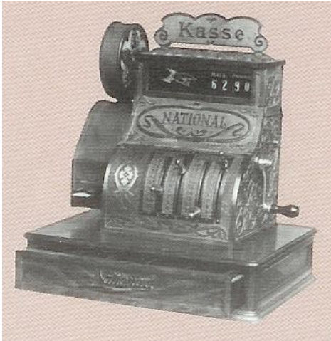
Figura 29 – Registradora alemanya de plaques amb nou calaixos i mecanisme d'impressió de 1908.
