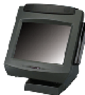
Figura 48 – Aquí podem observar un TPV, aquest es un dels models més nous, amb pantalla tàctil. Es el NCR Real POS 70.
