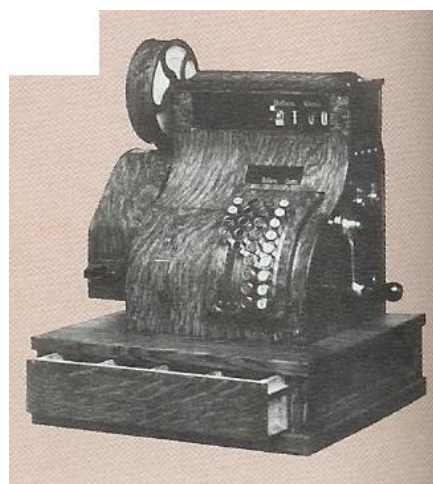
Figura 37 – Registradora NCR 600 construïda a partir de fibra de fusta. Aquesta màquina va començar a comercialitzar-se el 1916.
