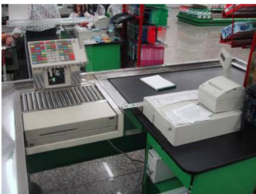
Figura 53 - Conjunt Terminal Punt de Venda d'una Sortida de caixa del Supermercat. On es pot observar el teclat i l'escàner.
