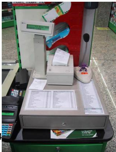
Figura 56 – Impressora tèrmica, on també podem observar el calaix per guardar els
